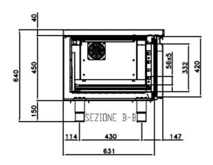
Tauwasserablauf und Elektroanschluss: 150 mm OKK – mittig nach unten im Maschinenfach
