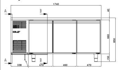
058 099 052 114 430 147 Tauwasserablauf und Elektroanschluss: 150 mm OKK – mittig nach unten im Maschinenfach
