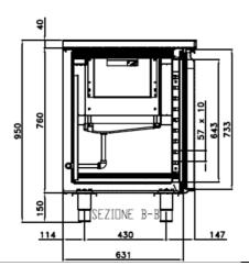
Tauwasserablauf und Elektroanschluss: 150 mm OKK – mittig nach unten im Maschinenfach
