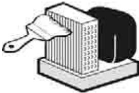
**Alle Reinigungsarbeiten des Kühlschranks sowie der eingebauten Kondensationseinheit sind bei ausgeschaltetem Gerät nach Unterbrechung der Spannungsversorgung auszuführen.**
