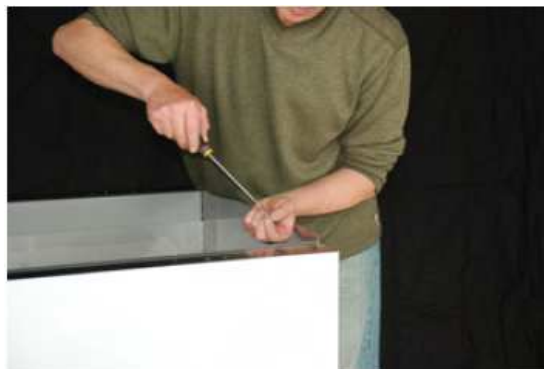
Den Boden unten innen verschrauben
