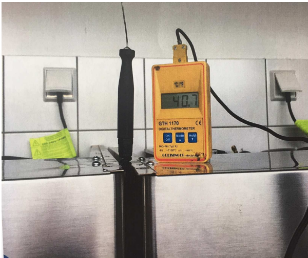
Umgebungstemperatur am Maschinenfach 40°C
